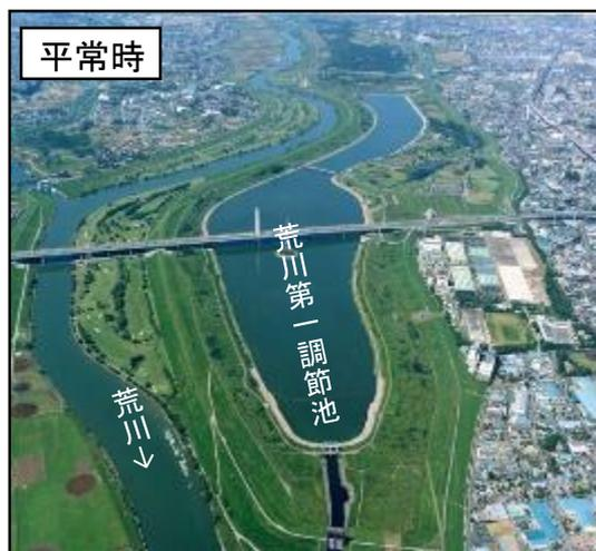
洪水時に調節池に一時的に貯留し、下流の河道流量を低減
