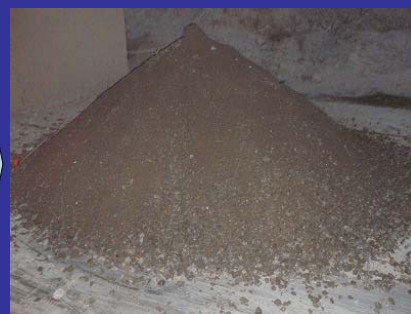
ガレキ破碎、事前混合処理土
