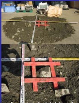
写真-1埋立材料(破碎前) 最大粒径200mm
