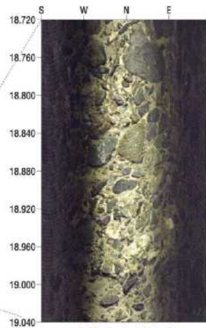
砂礫層の改良体写真 (ポアホールカメラにより撮影)
