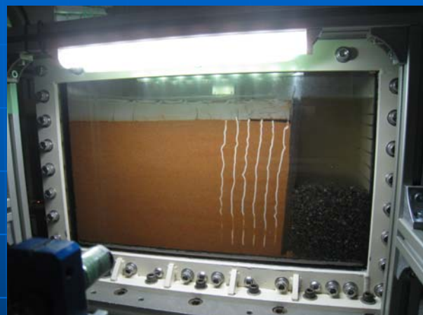
ドレーン遠心载荷実験の状況
