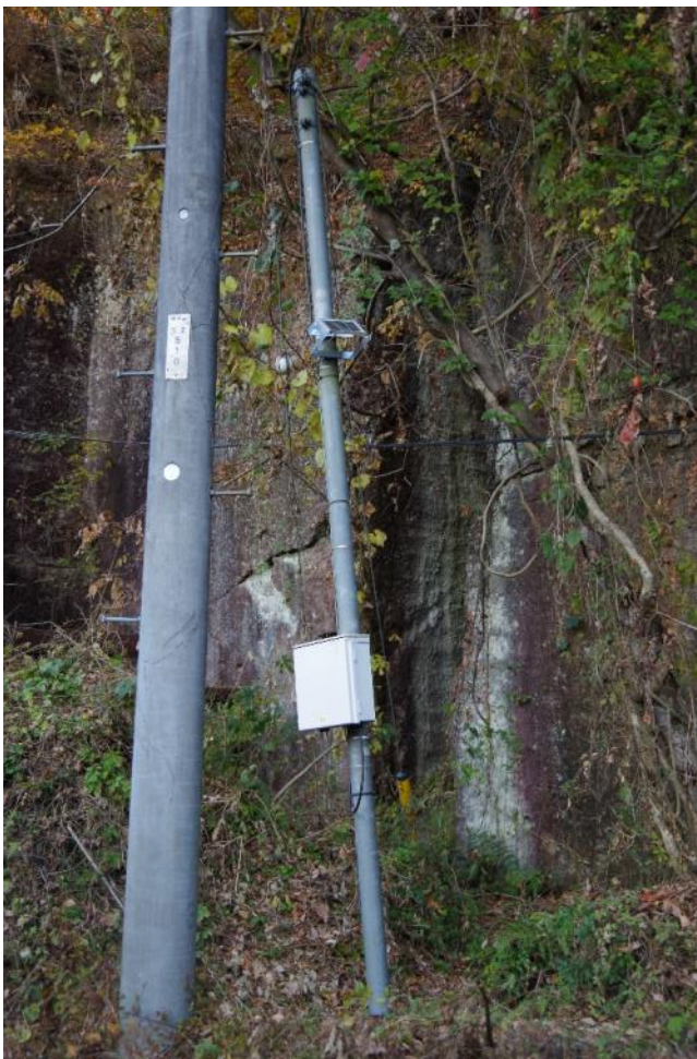
地底湖近くの地震計設置位置。ソーラー電池で駆動している。
