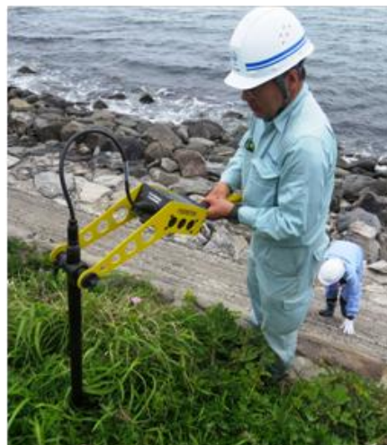
写真-2 金属探知器による危険物探査 日本物理探鑑(株) 内田篤貴氏による
