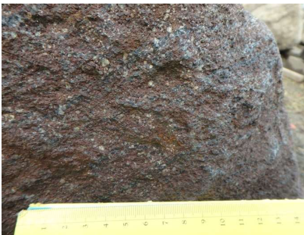
写真5. 江戸遺跡より検出された石材に使用される安山岩。流理構造を示す安山岩(An)。目盛りの幅は1mm。
