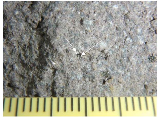
写真6. 江戸遺跡より検出された石材に使用される輝石安山岩(AnP)の接写。孔隙中に楔状～板状のトリディマイトが観察される(矢印)。目盛りの幅は1mm。
