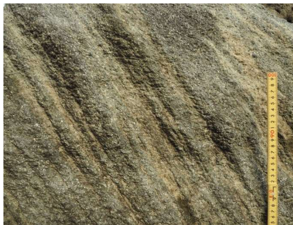
写真2 番場浦石丁場に分布する輝石安山岩(AnP)の接写。流理構造を示す。
