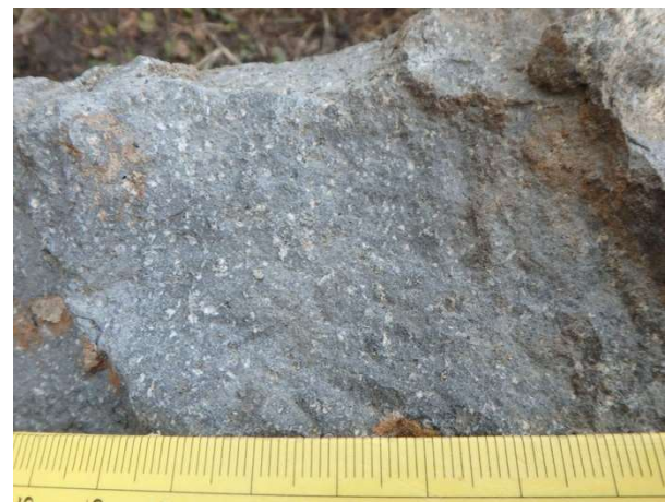
写真7. 江戸遺跡より検出された石材に使用される変質安山岩(AnA)の接写。目盛りの幅は1mm。
