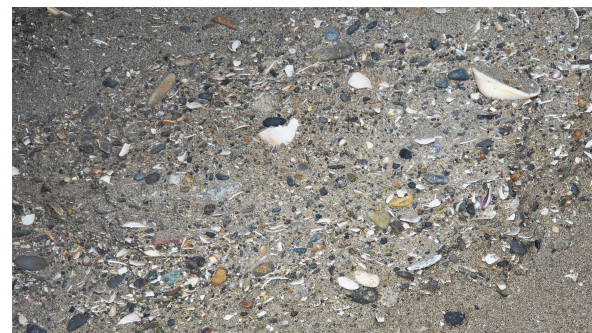
図 25 東側：盛土の礫交じり海砂の積層状況 撮影：2018.9.7
